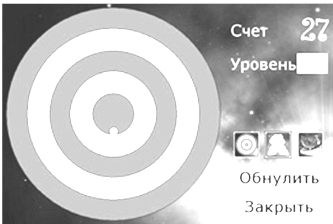
Рис. 2. Экран теста «Мишень» (на ST-150), где оценивается способность испытуемого удерживать отметку (соответствующую центру давления на стабиллоплатформу) в центре изображения.
