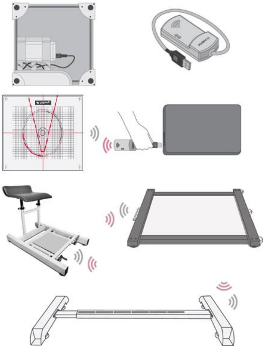
Рисунок 10 – Подключение взвешивающего модуля Системы к компьютеру через беспроводной интерфейс
